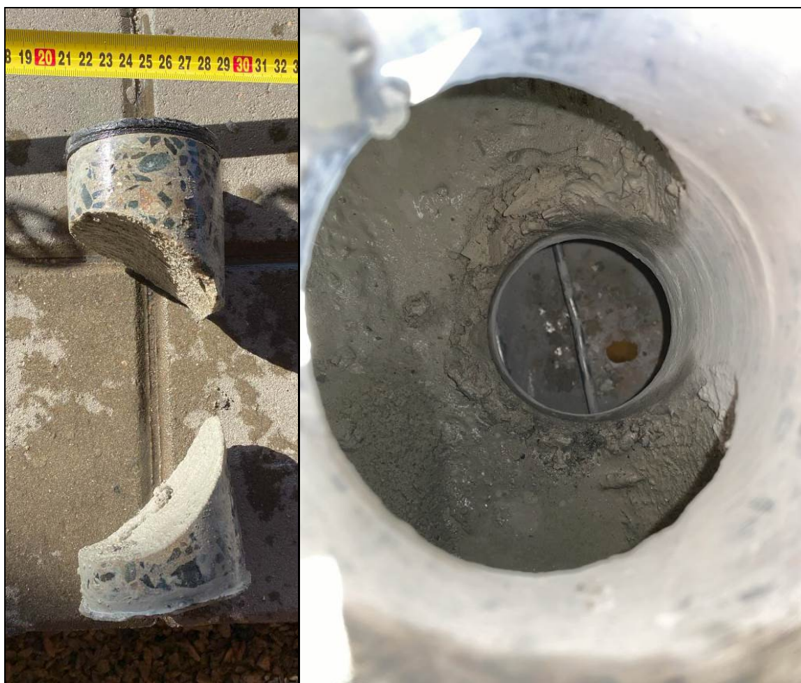
Obr. č. 20 - diagnostický vrt S1, vlevo - shora skrze strop z nástupiště do podchodu nad 1. PP (průvrt panelem Spiroll); vpravo – pohled shora do vrtu S1
