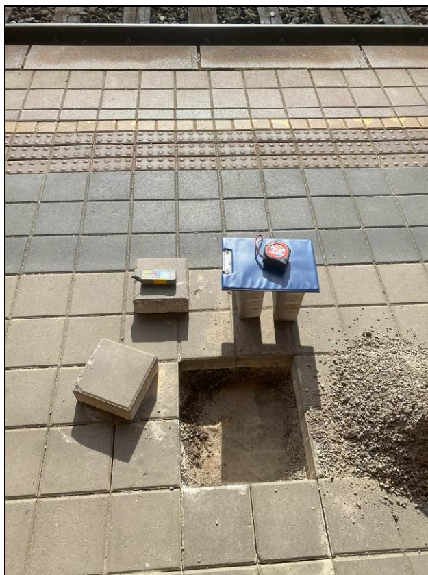
Obr. č. 25 - pohled na kopanou sondu KS2, na nástupišti č.1. Konstrukce pochozí plochy je tl. onstrukce pochozí plochy je tl. 120 mm
