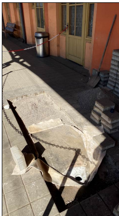
Obr. č. 24 - pohled na kopanou sondu KS1 a diagnostický vrt S1, skrze strop na nástupišti č.1. Konstrukce pochozí plochy je tl. 120 mm
